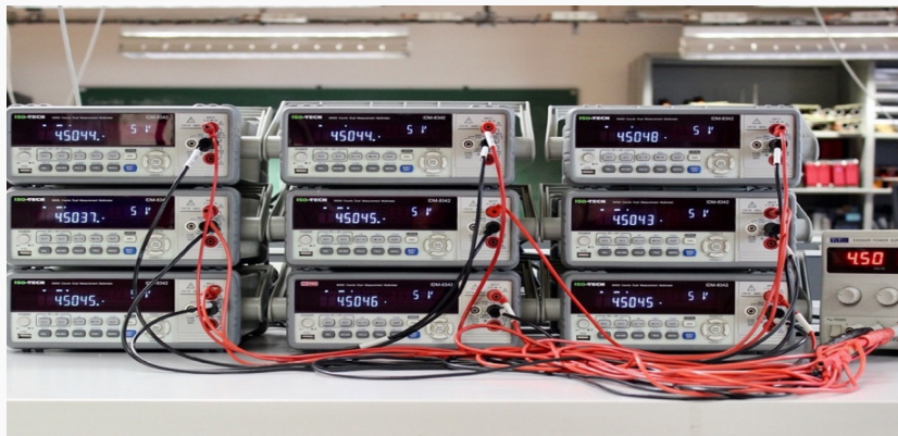
Figure 1 – Plusieurs voltmètres de la même référence branchés en parallèle sur une source de tension. Ils n'affichent pas la même valeur, mettant en évidence la variabilité cachée de la mesure d'une tension à l'aide d'un voltmètre unique.
