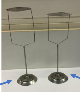
Panier pour échantillon de densité supérieure à 1
