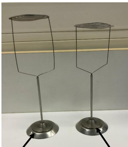
Panier pour échantillon de densité supérieure à 1
