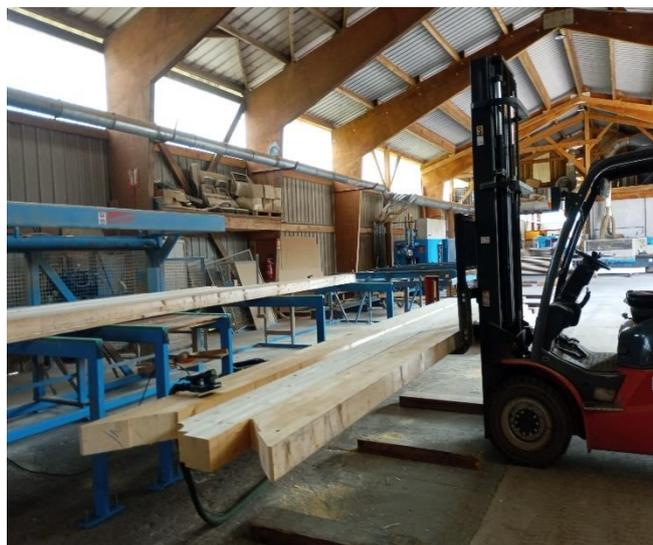
Actuellement, la sortie des pièces rabotées mobilise un manutentionnaire qui assure l'évacuation des pièces avec un chariot élévateur et nécessite l'arrêt du transfert en amont des charpentes pour des raisons de sécurité.
