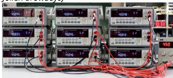
Figure 1 – Plusieurs voltmètres de la même référence branchés en parallèle sur une source de tension. Ils n'affichent pas la même valeur, mettant en évidence la variabilité cachée de la mesure d'une tension à l'aide d'un voltmètre unique. (Source : équipe technique de l'UFR de Physique de l'Université de Paris)
